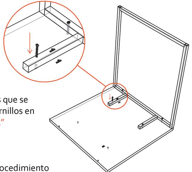
Teniendo ubicada la pata se procede a fijar con los tornillos que se encuentran en un empaque pegados a la superficie. son 8 tornillos en total (por mesa) 4 por cada pata. **Tornillo Goloso de 1"**
